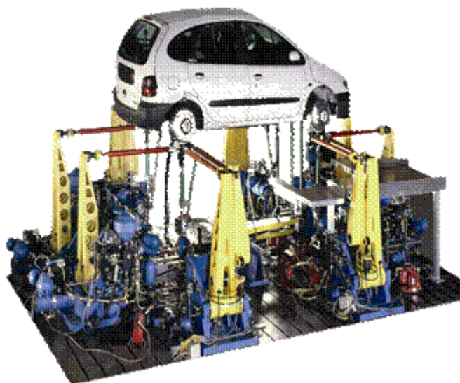
Рис. 1.18. Стенд для испытания конструкций
