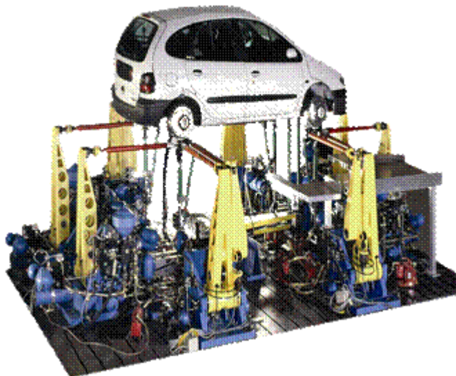
Рис. 1.18. Стенд для испытания конструкций
